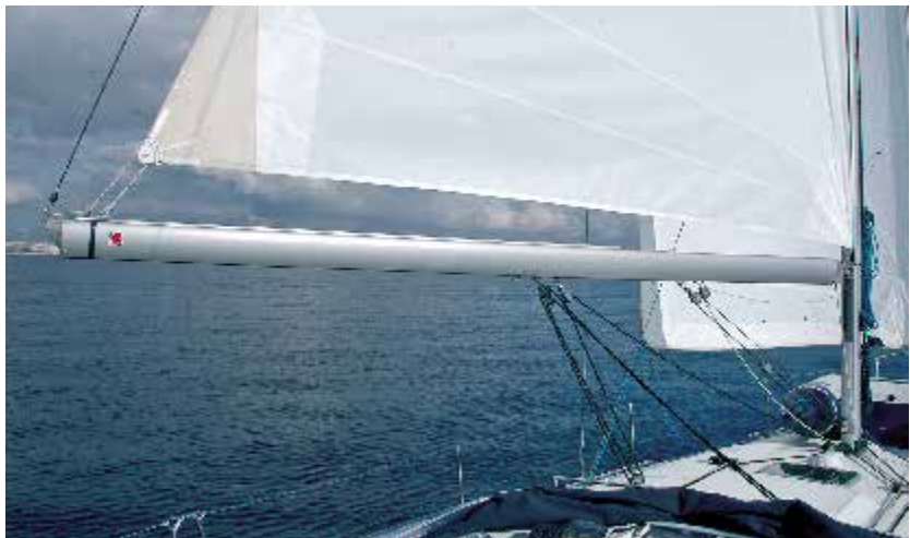
Das Rollgroßsegel der Testyacht (optional erhältlich) macht in Ausführung, Stand und Trimpotenzial keine gute Figur
