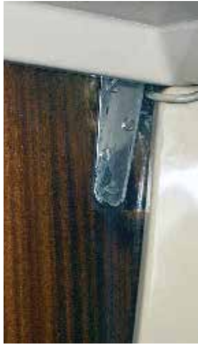
Kritisch: Häufig fault das Hauptschott auf den Dufours unter den Püttingen, solche Schäden müssen fachgerecht behoben werden und größere Schäden abzuwenden
