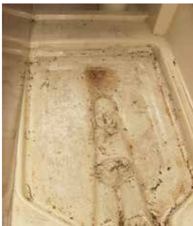
Der Kielbereich wird nur durch die Innenschale versteift, die Kielbolzen sind verspachtelt
