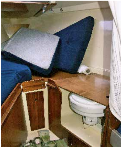
Unter der Steuerbord-Vorschiffskoje wurde ein Pump-WC eingebaut, das gut nutzbar ist
