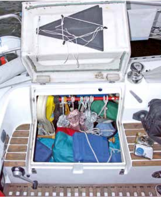
Durch den weit in das Süll gezogenen Deckel können auch sperrige Dinge in der Backskiste untergebracht werden.
