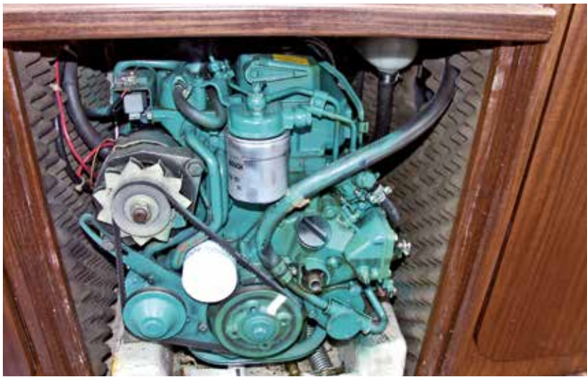
Die Maschine sitzt etwas beengt unter dem Cockpit, Zugang gibt es nur von vorn und über zwei kleine Klappen im Bad und in der Achterkammer. Die Geräuschisolierung funktioniert gut.
