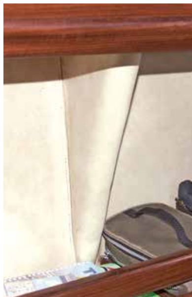
Leider ist nur das Oberwantspütting über ein Knie mit dem Rumpf verbunden.
