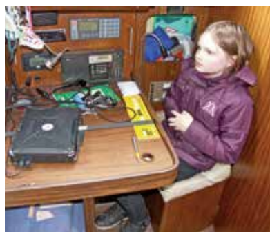
Die Navigation ist in Fahrtrichtung angeordnet und gut nutzbar, lediglich das Sitzpolster könnte konturiert sein, um bei Lage mehr Halt zu haben.
