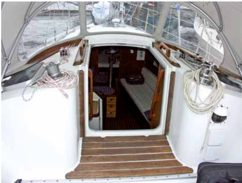
Der Niedergang ist weit nach vorn gezogen, man kommt aber dennoch auch bei hochgeklappter Sprayhood gut unter Deck. Auch die Fallwischen lassen sich ohne Probleme bedienen.
