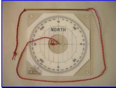
**Abbildung 4: Fertig zusammengesetzte Peilscheibe.**
