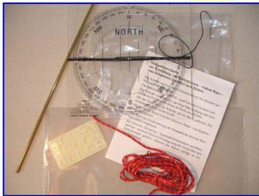
Abbildung 1: Material bestehend aus: Navigationsscheibe, Messingrohr, Anschlagdämpfer, Hammerschnur und Plastikhülle.
