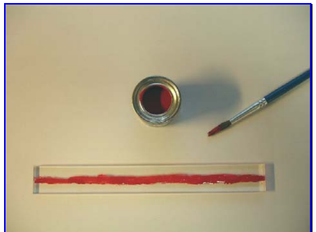
Einkratzen der Rille in die längliche Acrylglasplatte, verfüllen der Rille mit roter Farbe.
