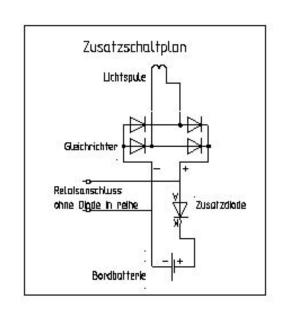
es geht auch mit der Gleichspannung nach dem Gleichrichter Zusatzschaltplan beachten
